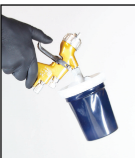
Закрытая система позволяет применять перевернутое распыление
